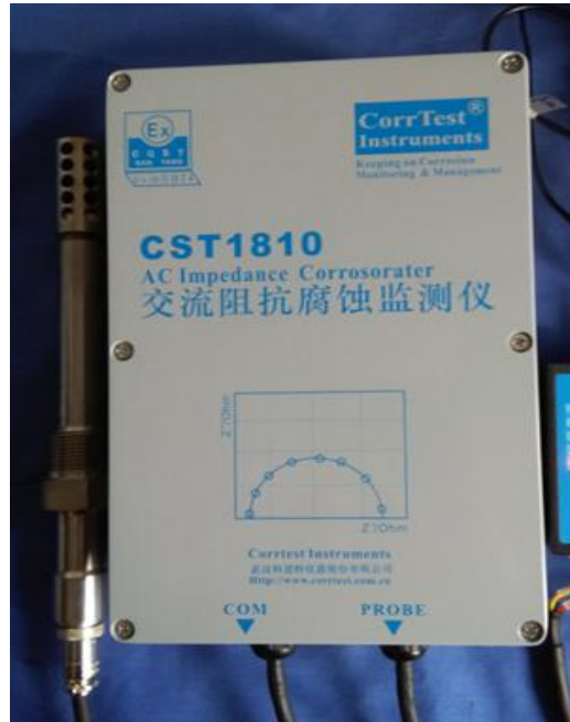
图3. CST1810 交流阻抗腐蚀监测仪及配套的土壤探头
