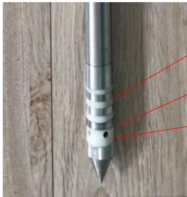
图3 土壤腐蚀监测探头
