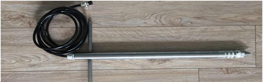
图3 土壤腐蚀监测探头
