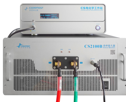
图 1. CS2100B 前面板电极线连接图
