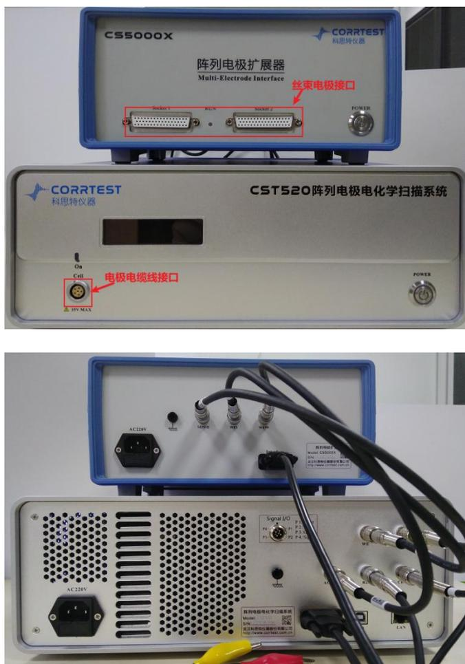
图 1 CST520 阵列电极电化学扫描系统与 CS5000X 阵列扩展器连接前后面板
