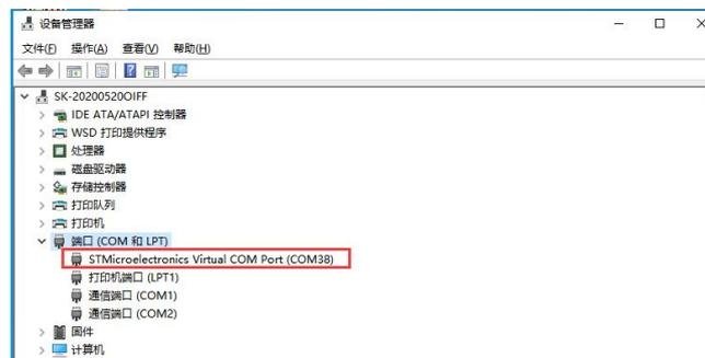
图 6 USB 驱动正确安装后设备管理器端口
